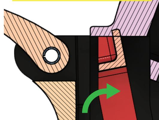
※解除されない場合は、レバーを押し込みながらセミオートで射撃してください。発砲音のあと「ワイン」と鳴ったら解除完了です。
