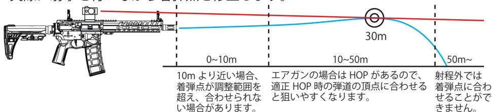
※図の例では 30m 先に概ねまっすぐ飛ぶように HOP 調節をし、サイトライン(視線)が 30m 先で交わるように調節しています。弾道と射手の視線は完全に同一にはならないため(目から弾が出るというわけではないため)、正しく着弾させるためには「弾道の調節」と、「どの距離でサイトラインを合わせるか」が重要となります。ゼロインを行った距離以外の着弾点は必ずサイトラインから上下にずれる事になります。
